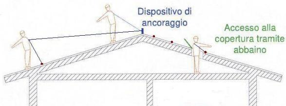
Per il montaggio del dispositivo DIMOS è necessario, in ogni caso, prevedere che l'altezza di caduta libera (tirante d'aria) sia priva di ostacoli anche se occasionali; linee elettriche accessibili in caso di caduta, devono essere protette.
