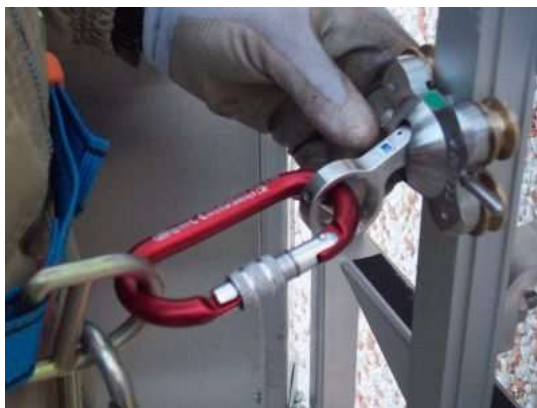
Carrello inserito correttamente (al centro a destra lo spinotto che impedisce l'inserimento scorretto; il lato alto al centro bollino verde)
