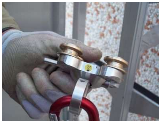
Lato inferiore del carrello con simbolo giallo di inserimento errato
