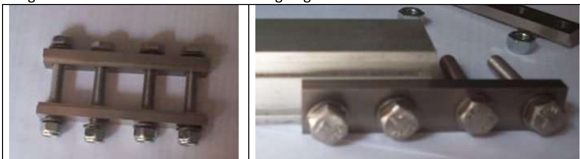
Giunzione esterna orizzontale
