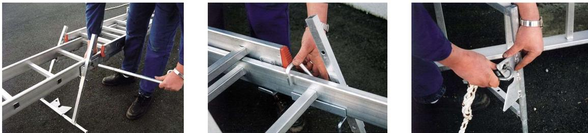
Dopo aver infilato la barra all'interno del piolo della scala, bloccare con i perni di sicurezza e le apposite coppie.
