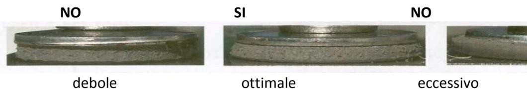
Figura 11: serraggio della rondella con guarnizione
