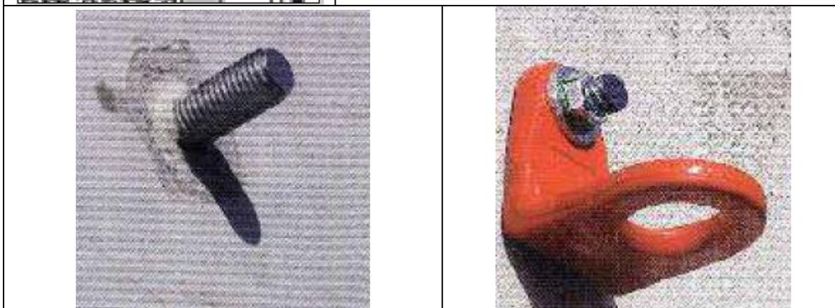
Su strutture in cemento armato, prive di fessurazioni o screpolature, è possibile utilizzare tassello meccanico HILTI mod HSL-3-B M12x50, con tappo rosso a rottura di coppia.
