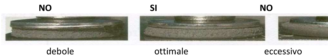
Figura 11: serraggio della rondella con guarnizione
