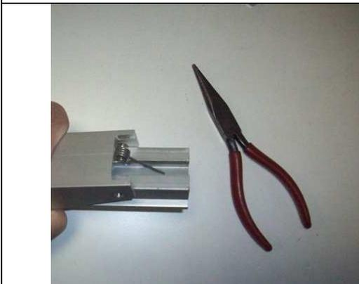
Inserire la molla nell'apposito foro e posizionare l'arresto sul binario; inserire la vite aiutandosi con le pinze per mantenere in posizione la molla.
