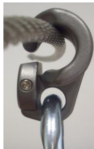
Il moschettone inserito nell'anello, impedisce lo sfilamento dalla fune
