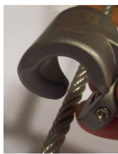
Senza il moschettone, il carrello può essere inserito sulla fune
