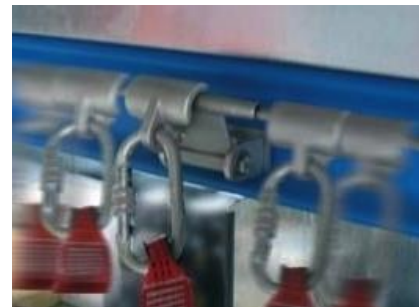
Il carrello consente di transitare sull'ancoraggio intermedio senza sganciarsi.
